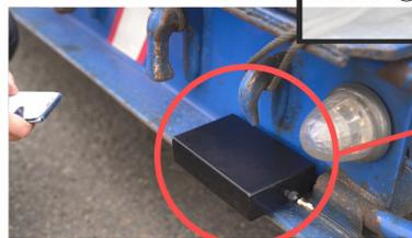
STEP① SLAS対応ICタグユニットをコンテナに設置
