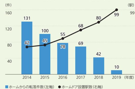
東急電鉄は、2019年度に大手私鉄において初となるホームドア・センサー付固定式ホーム柵の100%設置を実現しました(世田谷線とこどもの国線を除く)。
