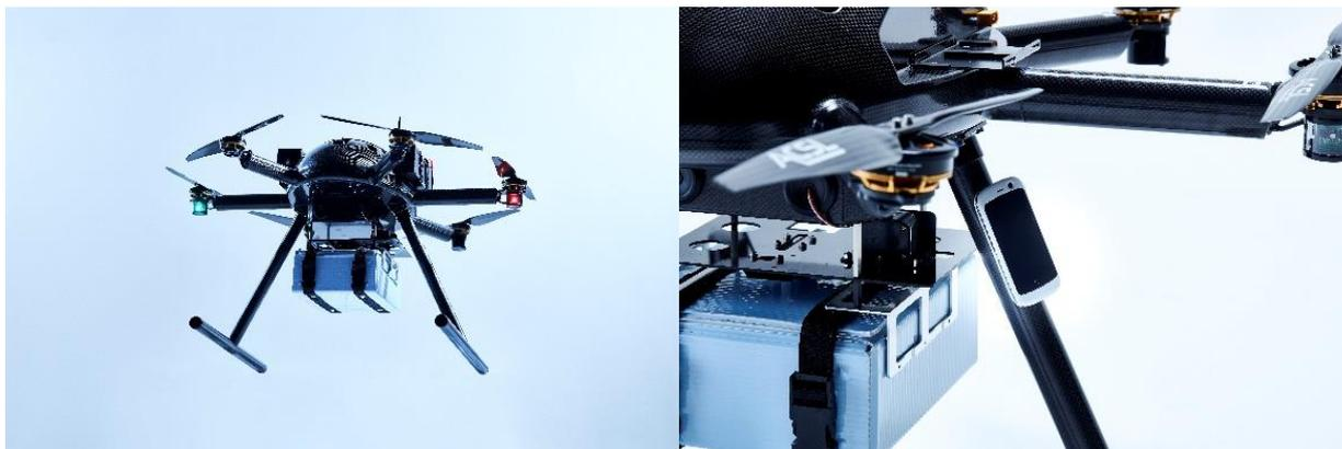
左：ACSL-PF2 物流用ドローン。往復飛行（荷物配送後、そのまま再離陸）が可能なキャッチャー（荷物搭載機構）を搭載
