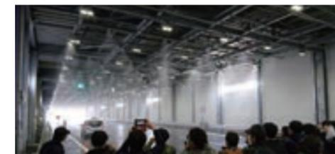
降雨設備では、1時間あたりの雨量を30mm、50mm、80mmの3段階で再現できる
