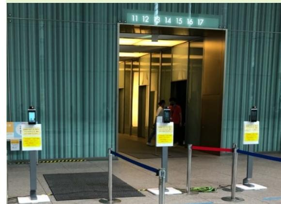
エレベーターホールの前に設置した最新のスタンド検温カメラは、AI機能によって人の顔を検出するため、マスク着用のまま僅か0.2秒で高精度な検知が可能。
