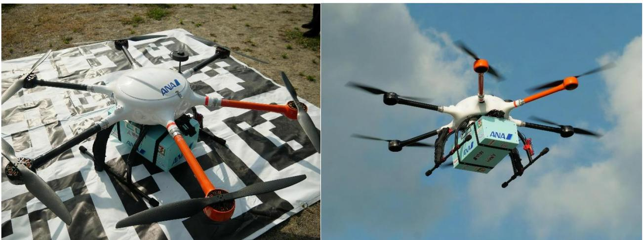
写真) 左：中型物流ドローン試作機、右：実証において実際に荷物を運ぶ様子
