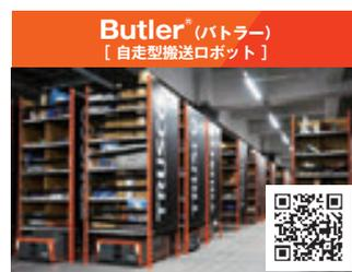
自走型搬送ロボットが棚を持ち上げ、作業者の元へ移動します。
