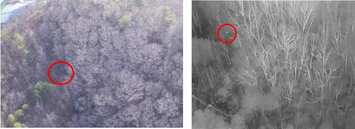
(写真) 左：4K 可視光カメラで撮影した様子、右：赤外線カメラで撮影した様子
