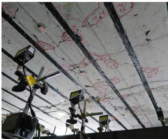
繊維補強供試体の輪荷重走行試験による効果
