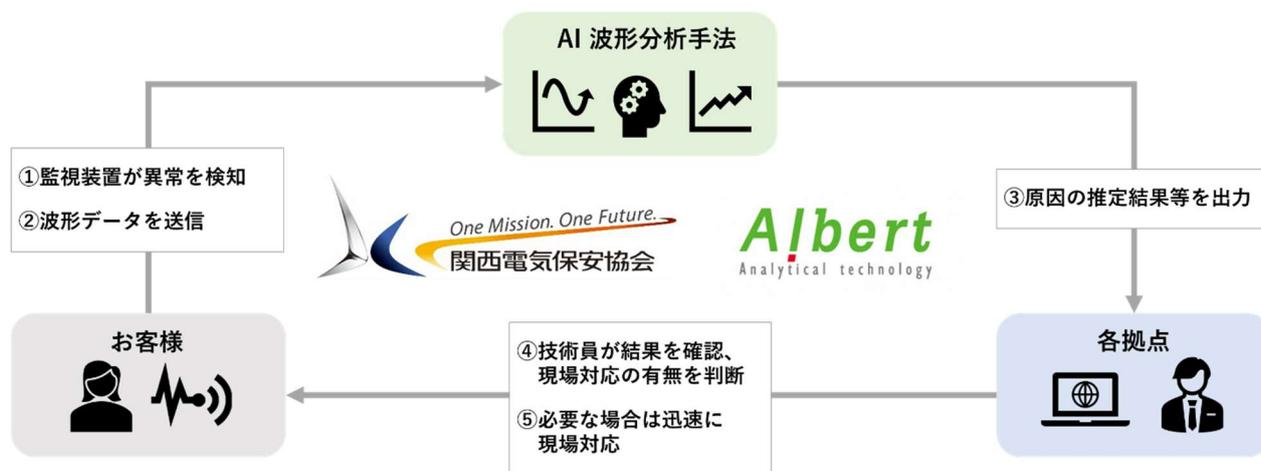
一般財団法人関西電気保安協会(大阪府大阪市、理事長 山地 進、以下 関西電気保安協会)と株式会社 ALBERT (アルベルト、東京都新宿区、代表取締役社長：松本壮志、以下 ALBERT) は、高圧受変電設備から発生する異常時の電圧電流波形データから AI が原因推定を行う「AI 波形分析手法」を共同で開発し、2021年12月24日より本格導入しました。これにより、異常時のデータを更に蓄積して原因推定の精度向上を図り、今後の保安管理業務のスマート化を目指します。
