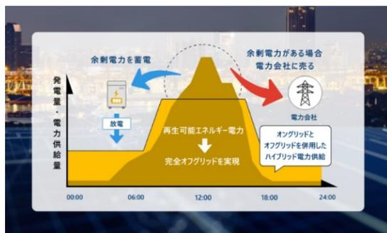
太陽光パネルをマンションの屋上に設置し、発電した電力を各住戸へ供給します。日中に発電した電力を大容量の蓄電池に溜めて日没後に供給します。それでも足りない部分のみを電力会社から供給し、「ハイブリッド型」の運用を行うことで環境にも貢献し、さらにコストの安い電気を供給することができます。
