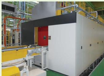
電気加熱式の真空浸炭炉
