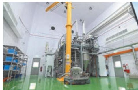
金属粉末製造装置(ガスアトマイザー)
