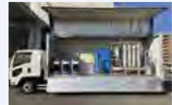
車載式セラミック膜ろ過システム
