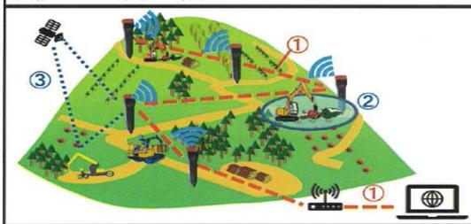
①通信機能付き作業杭を利用した通信ネットワーク構築
