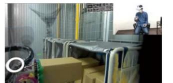
ゴーグルを通して映像を確認し、コントローラーで遠隔操作を行う
