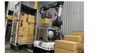
積み付け作業を行うロボット
