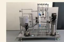
耐溶剤性分離膜プロセスのテスト機
