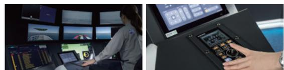
陸上側の非常対応ブロックに装備されたジョイスティックコントローラ。この小さなコントロールレバーを動かすだけでオートパイロットを操ることが可能
