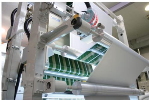
印刷品質検査装置
