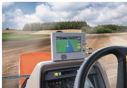
トラクタ直進自動操舵補助装置
