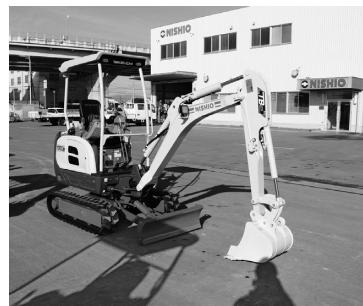
電動ミニバックホウ（電池式）「TB20e」
