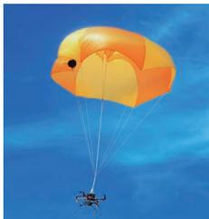
作動したPARASAFE®により降下中のドローン
