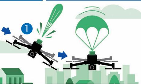
ドローンに装着したPARASAFE®が作動する様子
