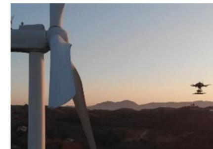
風力発電のブレード点検自動化
