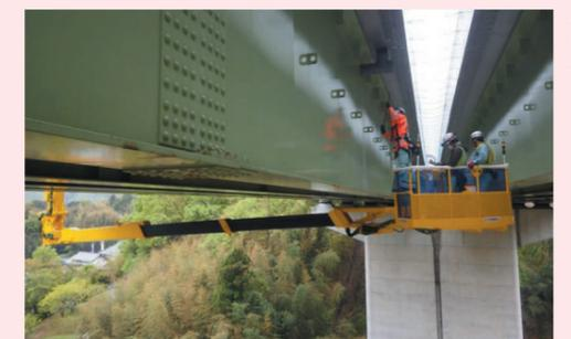
国内最大級の大型橋梁点検車「BT-400」
