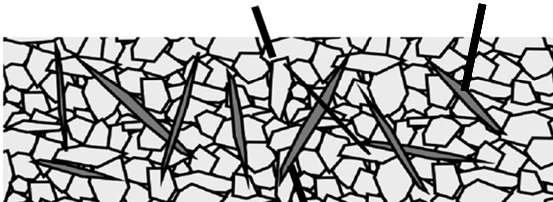
基板内部に柱状組織を実現することで、クラックの伸長を抑制し窒化アルミニウム基板の弱点である機械特性を向上させる
