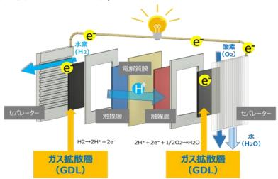
(\*) GDL (ガス拡散層、Gas Diffusion Layer) とは、燃料電池を構成する部材で、燃料であるガスの拡散、発生した水の排出や電荷の輸送など、燃料電池の効率と性能に重要な役割を果たすものです。
