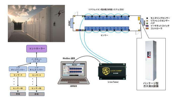
Li-ion Tamer®のオフガス早期検知技術は、リチウムイオン電池およびそれらが設置されている機器・設備・施設等の安全性を著しく向上させます。Li-ion Tamer®のオフガス早期検知技術は、熱暴走に至る前に発生するオフガスを検知するように設計されています。オフガスの早期の検知により、ユーザーは熱暴走の影響を回避または軽減するための予防的防災措置を講じることができます。
