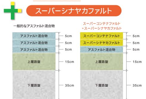
設計補修断面の比較
