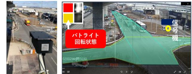
検知エリア（青・黄）のいずれも車両を検知していない場合、車両出入口に設置したパトが回転し、出庫可能の合図を出す
