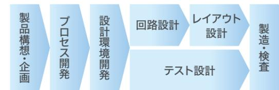
プロセス開発では製品構想に沿った性能を出すための素子構造をシミュレーションし、最適な工程や条件を開発します。サンケン電気の集積回路プロセスであるBCDプロセスには60～1200Vまでのラインアップがあります。
