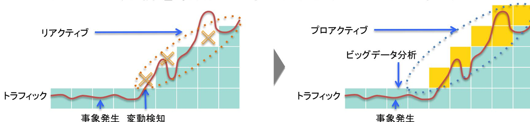
＜図1＞プロアクティブ制御
