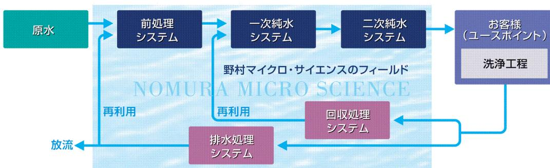
◎ 超純水製造装置システムの構成
