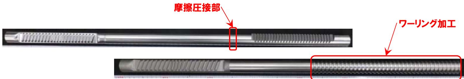
※ワーリング加工: ボールねじの切削加工方法の一種。
