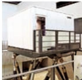
大振幅振動台 [E-Spider]。最大搭載重量3トン、加速度1G (3トン搭載時)、水平方向最大振幅±1.5m
