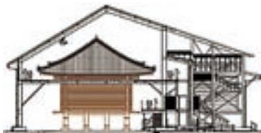
素屋根断面図。間口48m、奥行35m、高さ19m
