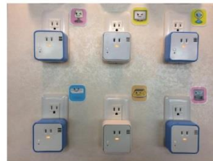
コンセントと連携して、電気使用量を測定
