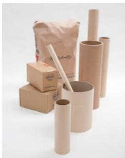
原紙に接着剤が塗布され、スパイラル状に巻き込み、管の状態にしていきます。
