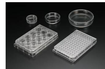
細胞シート回収用温度応答性細胞培養器材
