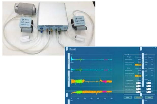
上腕に付けたカフに空気圧を加え、腕の阻血を行い、その後カフを緩めて、阻血前後の橈骨部や指尖部の脈波信号を近赤外 LED 光学式センサを用いて計測します。
