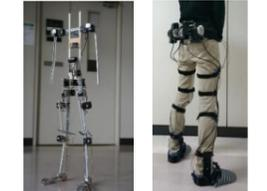
人の構造に近い人型ロボットとその技術を応用したアシストスーツ
