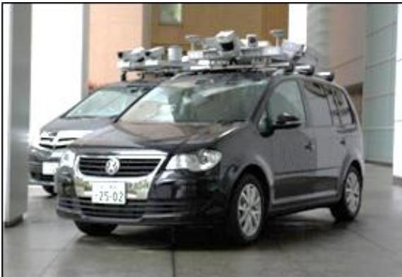
高精度計測車両
