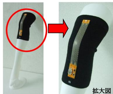
高柔軟FPCの市場開拓を進める中で、人や人型ロボットにおいて肘や膝の関節が曲げ伸ばしするためには、50%程度の伸長が要求されるものの、現行の蛇腹形状の銅回路では20%程度の伸長となり、耐久性も劣る状態でありました。また、材料の見直しによる伸縮性銀ペーストの採用により高い伸長は期待できるものの、微細回路化やはんだによる電子部品の実装に課題がありました。
