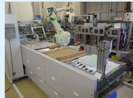
中央試験センターでは、作業効率の改善を目指して、自動試料分取装置を開発・設置
