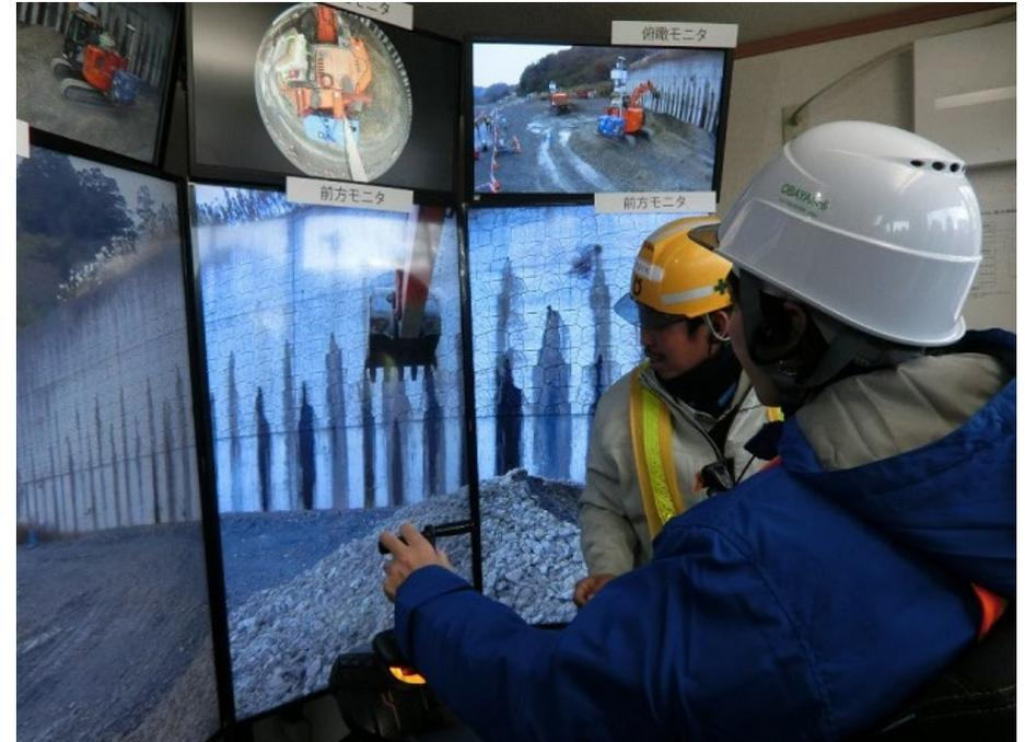
同時に多数の無人の機械を遠隔操作（多数同時接続）
