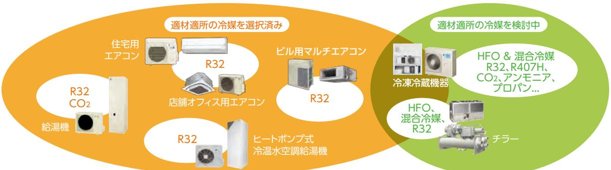
注) ダイキンが現在販売している代表的な製品についての冷媒選択の方向性を示しており、その他の製品では上図で示す冷媒以外にも使用される可能性があります。例えば、当社では製造していませんが、ウインド型エアコンや家庭用冷蔵庫には炭化水素系冷媒(インソタン、プロパンなど)、カーエアコンにはHFO系冷媒が使用できる可能性があります。
