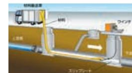
③ 材料の加熱硬化
