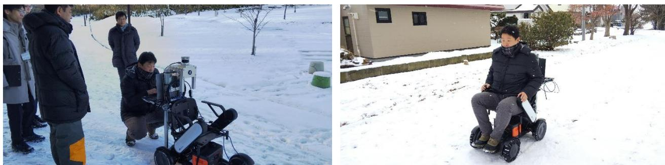
Fig-1 調査状況(左:電動車椅子に搭載したセンサーと調整状況、右:環境データ取得作業)
