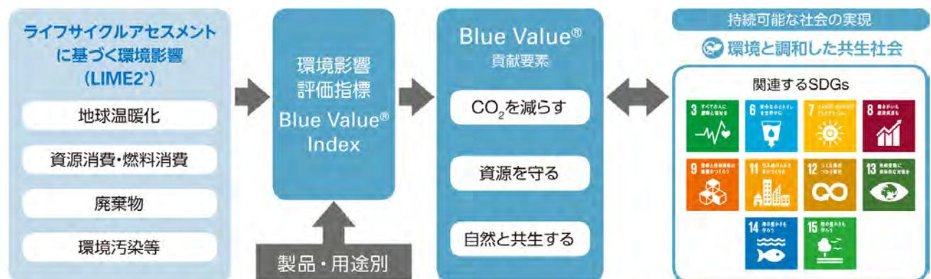
※ LIME2 (Life-cycle Impact assessment Method based on Endpoint modeling) : 日本の環境条件を基礎とした被害算定型ライフサイクル環境影響評価手法。
