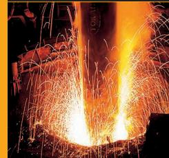
黒鉛電極は、スクラップ（鉄くず）を溶かして鉄ヘリサイクルする電気炉での製鋼において、導電体としてなくてはならない中心的な素材です。約1,600°Cの高温になってスクラップを溶かします。
